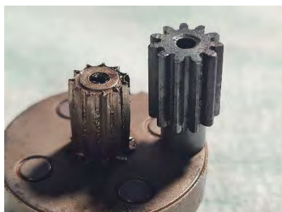
Slitet kugghjul 430X vs härdat
